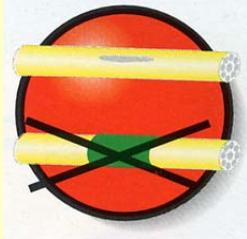
Une gaine de câble blessée ne doit pas être réparée par un adhésif.
